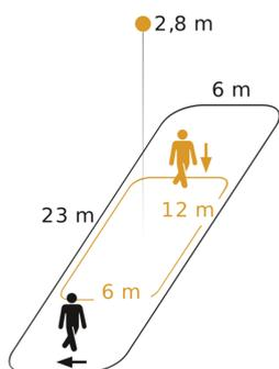
Possibile altezza di montaggio: 2,50 m - 5,00 m
